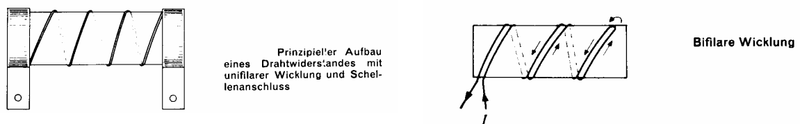
Fig. 2-29 Drahtwiderstand (unifilar und bifilar). (Aus [L 2-1], S.56)
